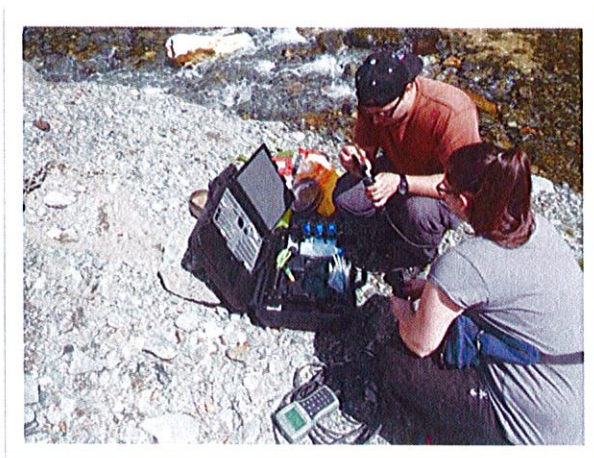
Figura 31. Măsurarea turbidității apei cu ajutorul analizorului portabil multiparametru Hanna 9289
